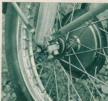
Die Vorderradachse wird in dieser Weise festgehalten. Ein bißchen dünn, so meint man. Doch sollte man sich erinnern, daß unser „Grüner Elefant“ genau solche Vorderradachs-Aufhängung hat und das hält sogar wildeste Seitenwagenprügelei aus, über die kein Mensch heute noch ein Wort verliert.
