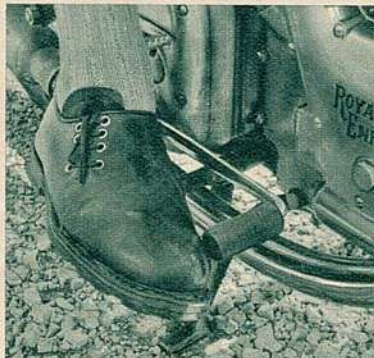
Rätsel: Bei welchem Bild sitzt der Mann auf der Sitzbank und bei welchem Bild steht er in den Fußrasten? Links sitzt er und rechts steht er! Eine bessere Demonstration guter Fußhebelage ist wohl kaum möglich. Es ist eine Freude, mit einer solchen Maschine im Gelände herumzufuhrwerken. Der Bremshebel auf der anderen Seite liegt genauso.
